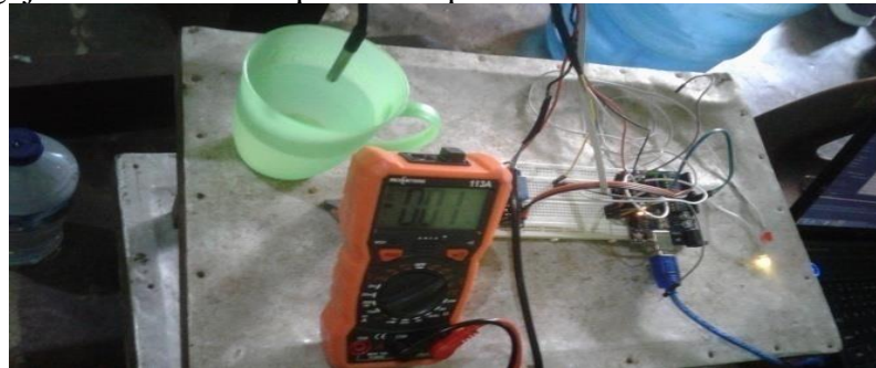
Gambar 2. Pengujian sensor suhu DS18B20
