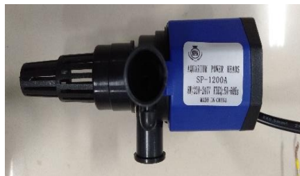
Gambar Pompa Air (Sumber: Dokumentasi Pribadi, 2019)
