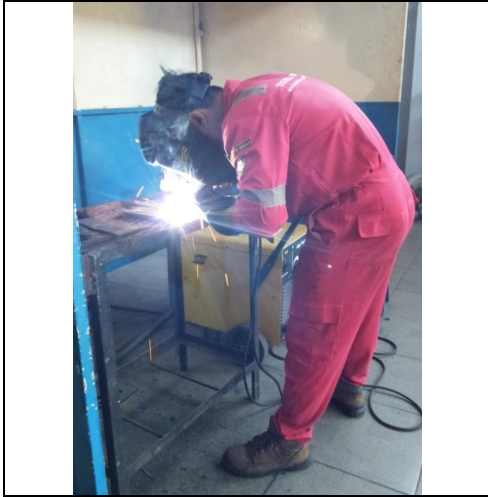
Gambar. 3.3 Proses Pengelasan Sudut Kampuh V
