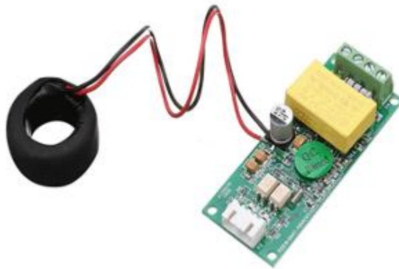
Gambar 2. Bentuk Fisik Sensor PZEM-004T
