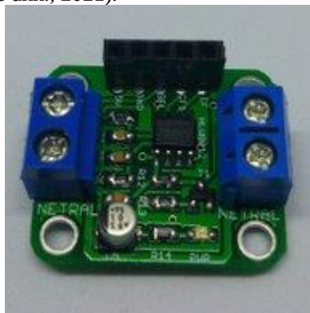
Gambar 1. Bentuk Fisik Sensor HLW8012
