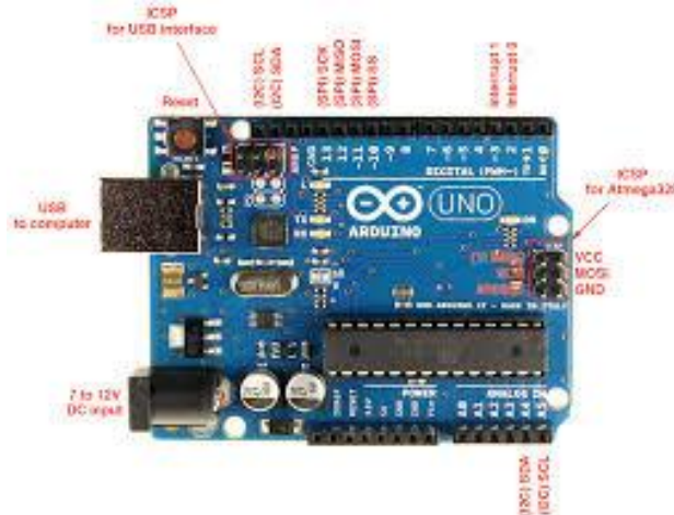
Gambar 3. Arsitektur Arduino Uno
