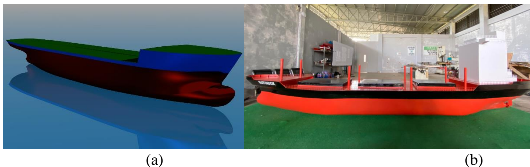
Gambar 3. a) Model kapal dalam software dan b) model kapal setelah di cetak alat simulator stabilitas kapal
