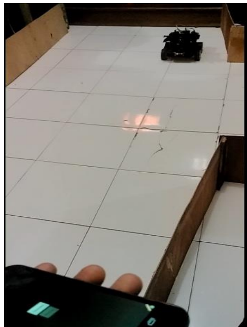
Gambar 7. Pengujian Robot yang melakukan scanning jarak halangan
