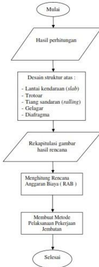
Gambar 4. Flowchart Desain Ulang jembatan
