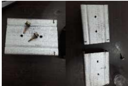
Gambar 4. 2 Baja Yang Sudah Di Uji
