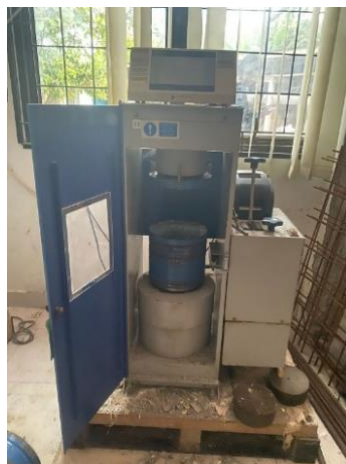
Gambar 2 . Setup Alat Uji Tekan
