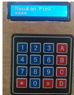
Gambar 3. Keypad dan LCD
