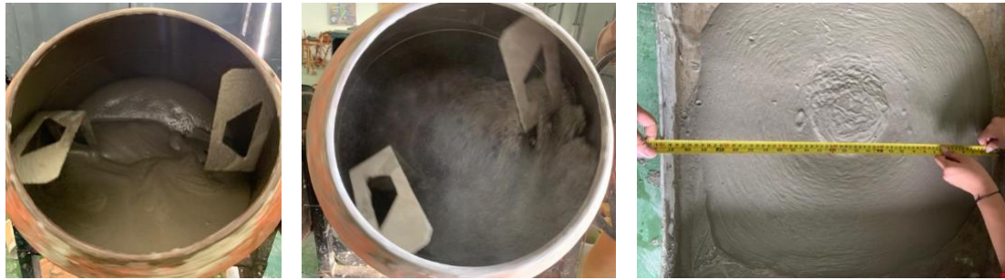
(a) (b) (c) Gambar 5. (a) (b) Pengadukan Campuran dengan Foam (c) Pengujian Slump Flow
