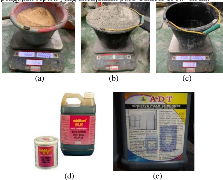
Gambar 3. Persiapan Bahan (a) Pasir, (b) Semen, (c) Air, (d) Additon HE, (e) Foam
