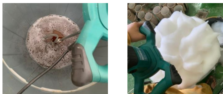
Gambar 3. Persiapan Bahan (a) Pasir, (b) Semen, (c) Air, (d) Additon HE, (e) Foam
