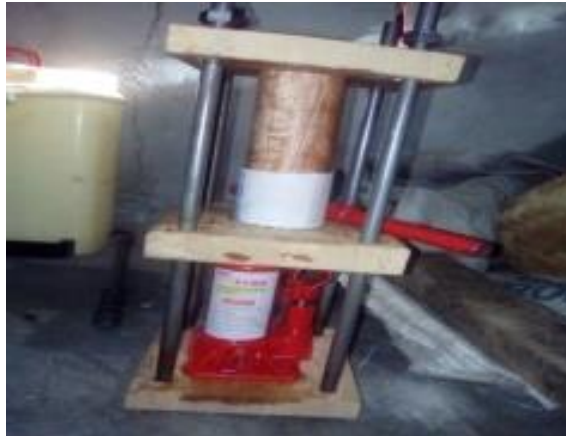
Gambar 2 Alat pencetak briket sederhana
