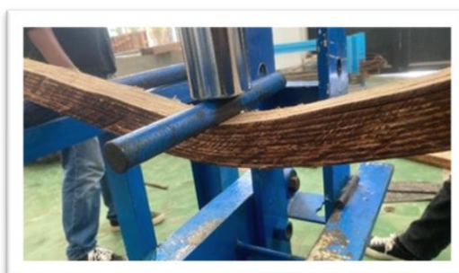
Fig. 2. Gambar keruntuhan balok
