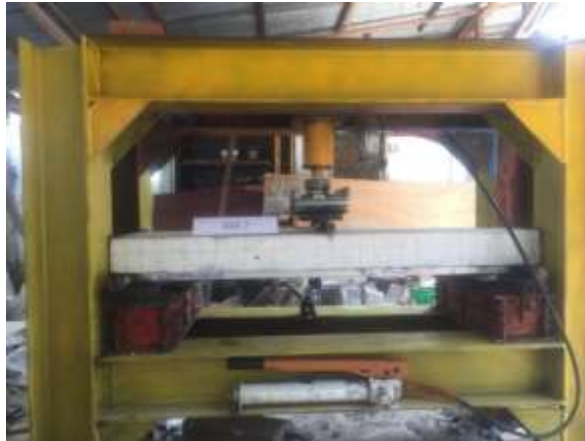
Gambar 4. Setting Up pengujian lentur untuk pelat
