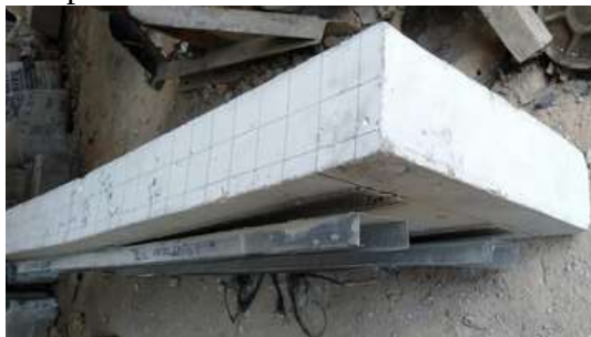
Gambar 6. Kondisi pelat perkuatan setelah pengujian lentur
